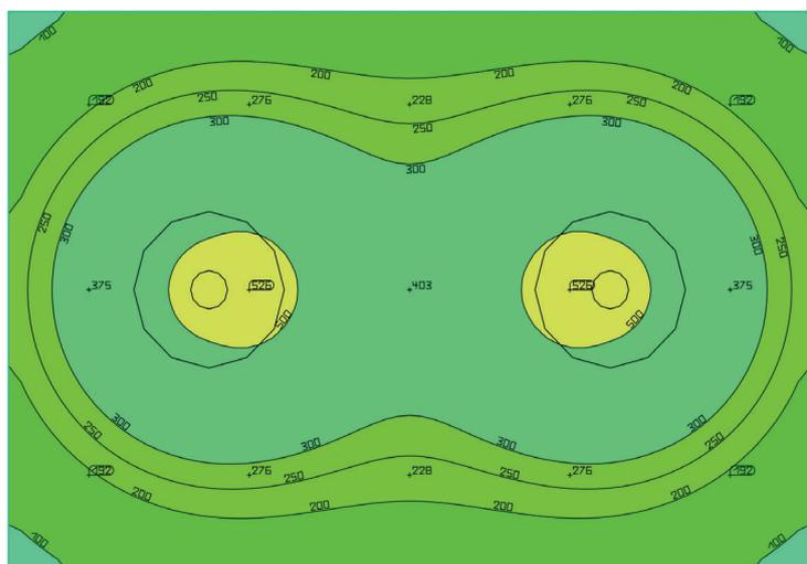
PPFD sobre 1x1m with Optica 60° to 0.750 m de distancia de la fuente luminosa
